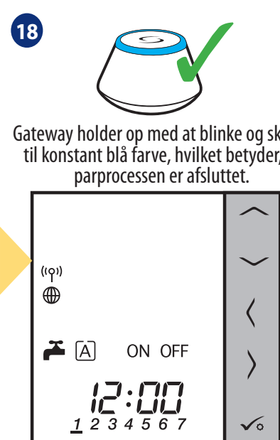
Efter denne termostat viser hovedskærmen. Du har med succes konfigureret VS10WRF/ VS10BRF termostat som varmtvandstimer med RX10RF -modtager.
