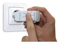
Dru "cken Sie die Taste des Repeaters. Die LED wird nun durchgehend Rot leuchten und zeigt an das dieser mit dem Netzwerk verbunden ist.
