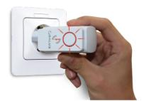
7 Dru "cken und halten Sie die Taste des Koordinators um den Pairing-Modus zu schließen. Die LED wird dann durchegehnd Rot leuchten.
