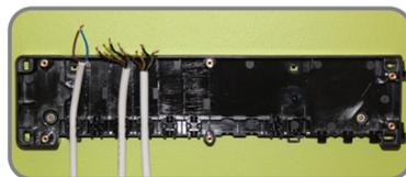
**9** Montieren Sie die Leitungen der Stellantriebe wie unten abgebildet in der KL08NSB. Sie können bis zu 4 Stellantriebe je Zone anschließen.
