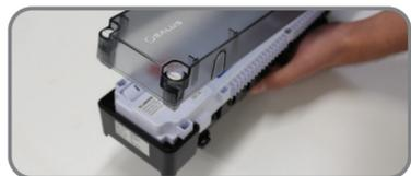
**5** Montieren Sie die Anschlussleitungen für Spannungsversorgung und Thermostate in ihre Position. Abbildung zeigt: Anschlussleitung Spannungsversorgung sowie 2 Thermostate.
