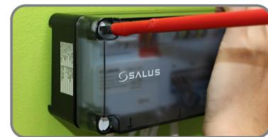
**15** Schalten Sie den Strom an um die Klemmleiste zu versorgen. Die rote LED signalisiert Betrieb.
