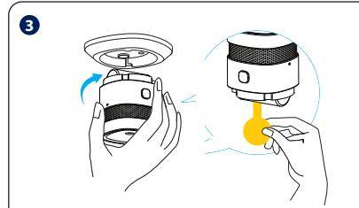
3 Zdejmij pasek izolujący baterię aby włączyć czujnik i zamontuj go w uchwycie obracając nim zgodnie z ruchem wskazówek zegara.
