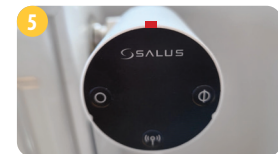
Apăsăți orice buton pentru a începe procesul de adaptare a capului TRV cu robinet termostatic. Procesul durează până la 5 minute.
