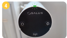
LED-ul va începe să clipească verde / roșu, informând despre versiunea de software.
