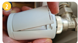
Scoateți capacul bateriei situat pe partea laterală a dispozitivului.
