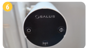
Când LED-ul se stinge și capul TRV nu mai emite niciun sunet, procesul de adaptare este finalizat. Echipamentul este pregătit pentru împerechere cu termostatul.
